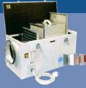
Höheren Komfort und reine Luft für Allergiker bietet der separate elektrostatische Pollenfilter AF400. Er filtert selbst winzige Schmutzpartikel aus der Luft, wie zum Beispiel Ruß oder Feinstaub. Sein Aktivkohlefilter beseitigt auch viele unangenehme Gerüche. Der Einbau erfolgt direkt in der Zuluftleitung hinter dem Lüftungsgerät.
